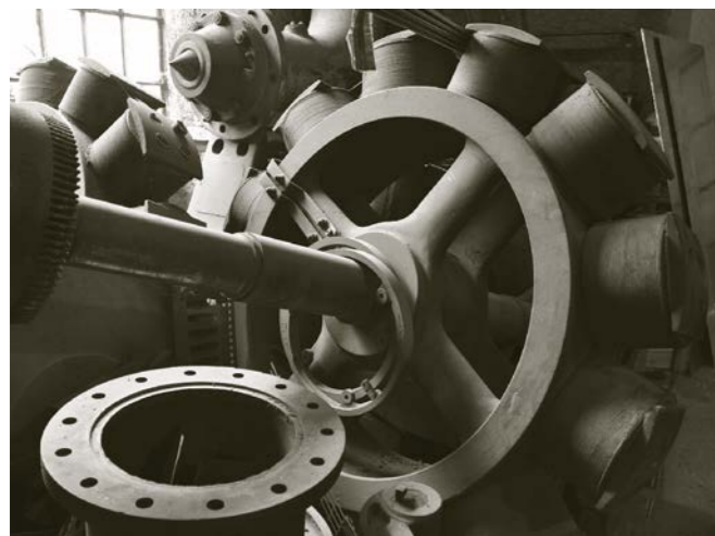
Rotor desmuntat corresponent a l'alternador 1 de la central Freser Superior. (AAM)
